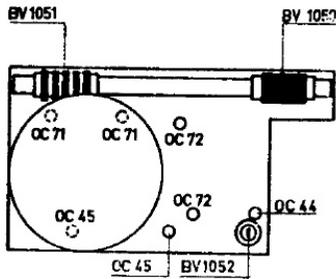
Abgleichpunkte: MW-Oszillator 515 kHz BV 1052
